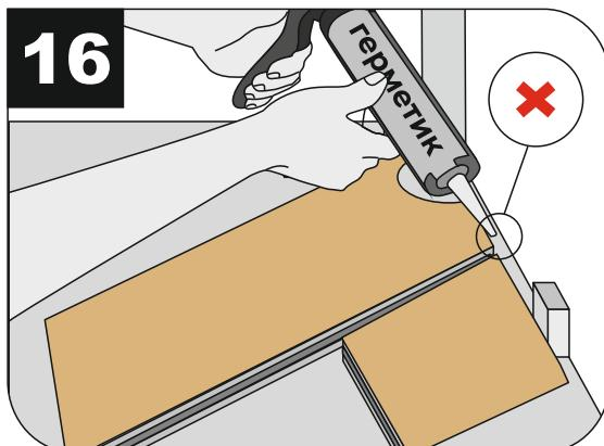
**7.8.1** Необходимо соблюдать монтажные деформационные зазоры не менее 8 мм от края покрытия до всех выступающих из основания пола конструкций и элементов (трубы, дверные и оконные рамы, лестницы, колонны, перегородки, пороги, любые крепежные элементы и т. п.).
